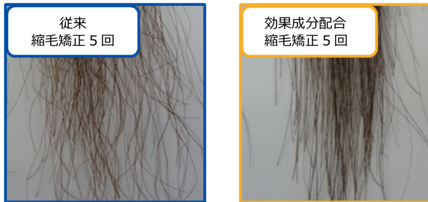
図3 効果成分（アセチルグルコサミン）の有無による縮毛矯正剤の仕上がりの違い
